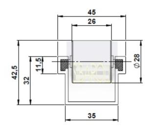
Comprimento Máximo 6000mm ±5mm
